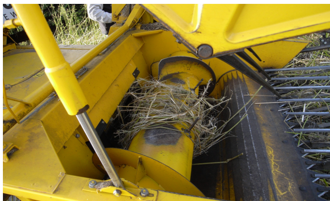
Foto 17. Det vil være en fordel, hvis flere af piggene på indføringstromlen afmonteres før høst af hamp. Fotograf: Lars Egelund Olsen, Videncentret for Landbrug.
