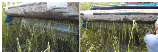
Foto 4 og 5: Lange hampestængler vikled sig ind i ribbebordet og forårsagede driftsstop. Fotograf: Lars Egelund Olsen, Videncentret for Landbrug.
