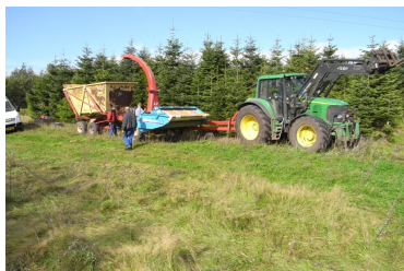
Foto 1: Ribbebordet er monteret på en bugseret JF snitter. Fotograf: Lars Egelund Olsen, Videncentret for Landbrug.
